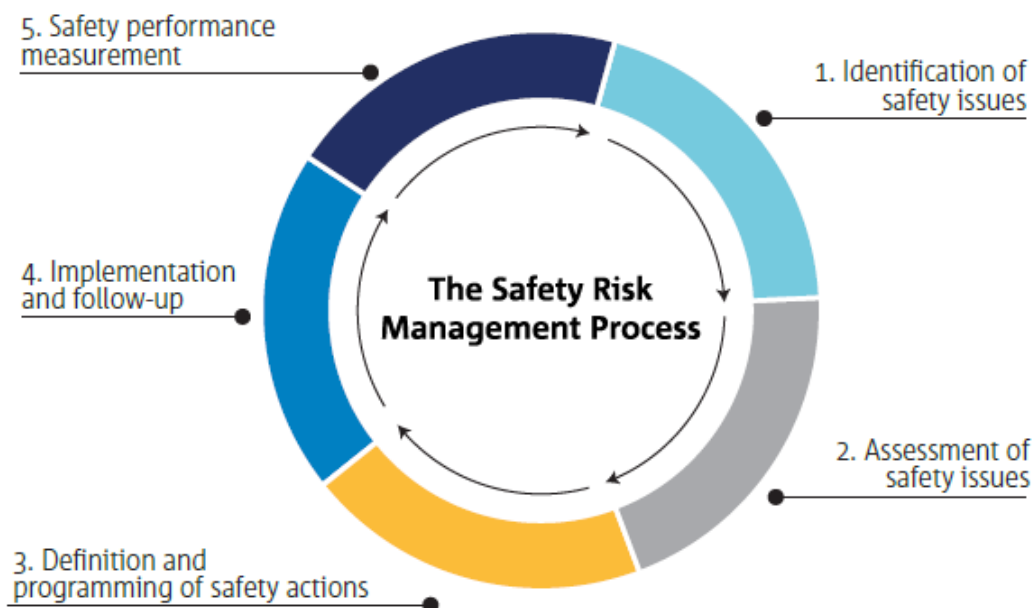
Figura 2 – Sistema de Gestão de Risco de Segurança Europeu | Figure 2 – European Safety Risk Management System
